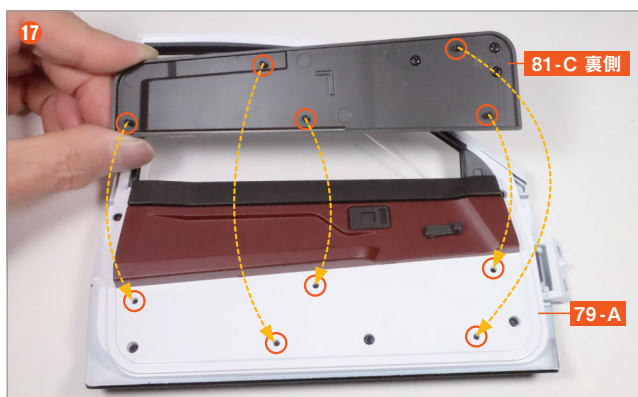
將 81-C 背面側的五處突起部分各自對齊 79-A 的五處凹槽，並嵌合固定。
